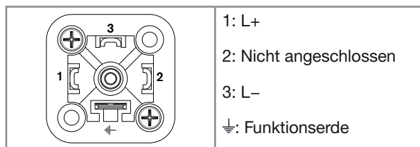
Fig. 3: Steckerbelegung des Gerätesteckers
