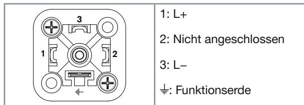
Fig. 3: Steckerbelegung des Gerätesteckers
