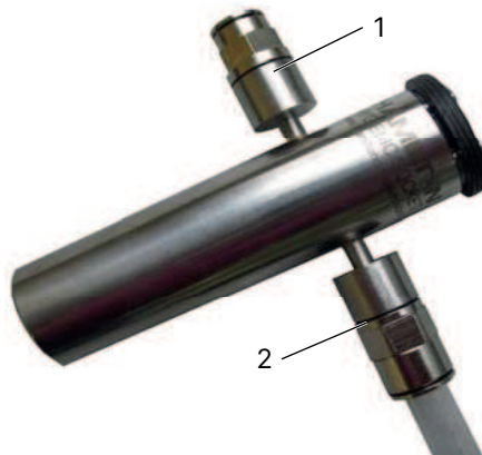
Fig. 3: Nettoyage du support avec des adaptateurs de nettoyage
