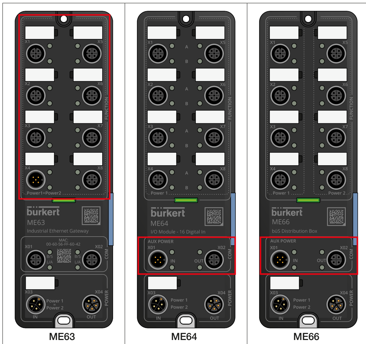
Bild 5: Spannungsversorgung über bus Anschluss
