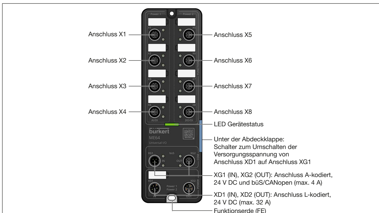
Bild 1: Ansicht des I/O-Moduls Typ ME64 Universal I/O
