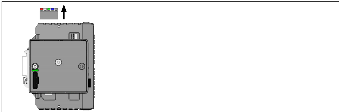
Figura 30: Remover a conexão por mola de 5 pinos
