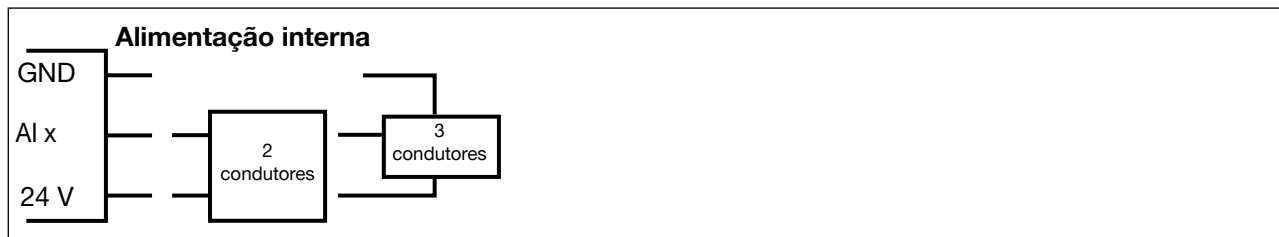
Figura 8: Circuito do módulo 4AI, alimentação interna
