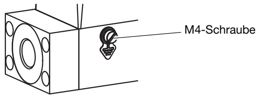
Abb. 15: Position der M4-Schraube für den Anschluss der Funktionserde
