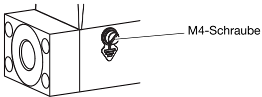
Abb. 20: Position der M4-Schraube für den Anschluss der Funktionserde
