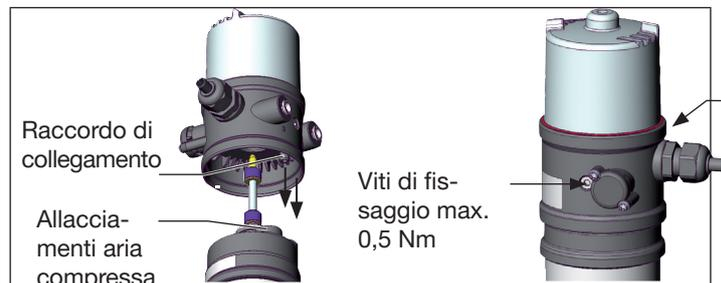
Figura 9: Montaggio del controllo pneumatico, serie 21xx
