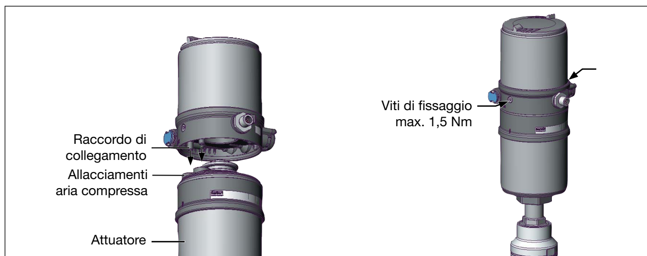
Figura 22: Montaggio positioner, serie 2103, 2300 e 2301
