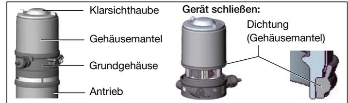
Bild 39: Gerät öffnen oder schließen
