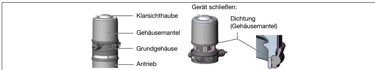
Bild 36: Gerät öffnen oder schließen
