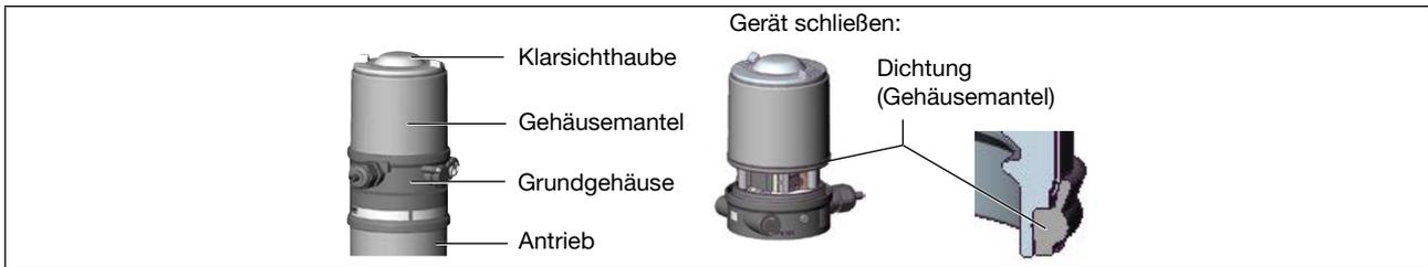
Bild 33: Gerät öffnen oder schließen
