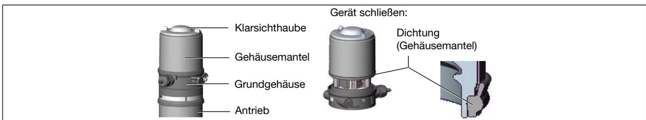
Bild 45: Gerät öffnen oder schließen
