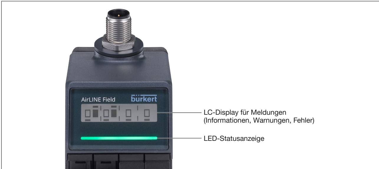
Bild 19: Anzeigeelemente Feldmodul AirLINE Field Typ 8653
