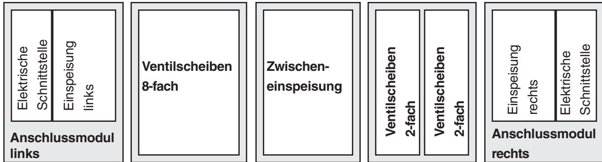
Beispiel eines Ventilblocks, schematisch
