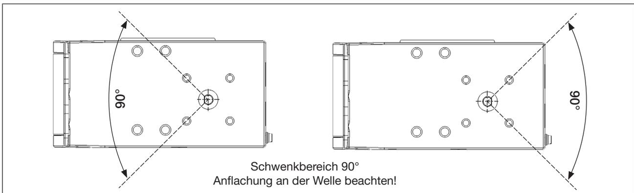
Bild 22: Schwenkbereich
