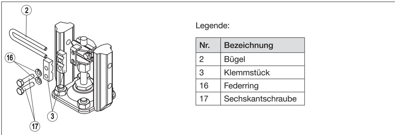
Bild 16: Montage des Bügels
