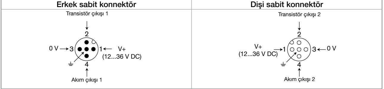
Şekil 21 : Erkek ve dişi M12 sabit konnektörlerin pin ataması
