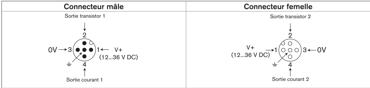
Fig. 21 : Affectation des broches de l'embase M12 mâle et de l'embase M12 femelle
