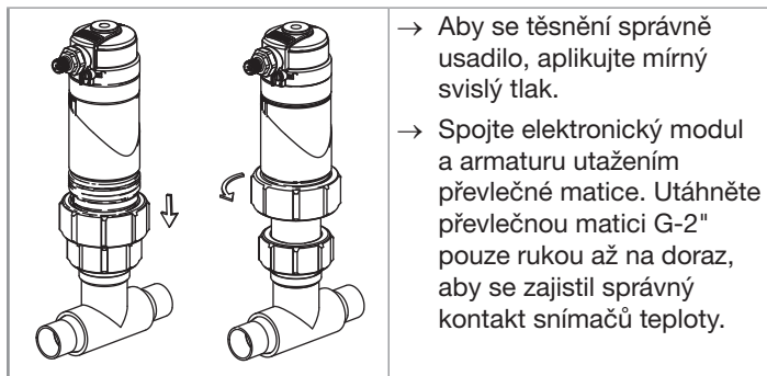
Obrázek 13 : Připevnění elektronického modulu k armatuře
