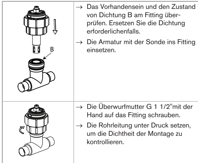
Bild 12 : Installation der Armatur in einem Fitting
