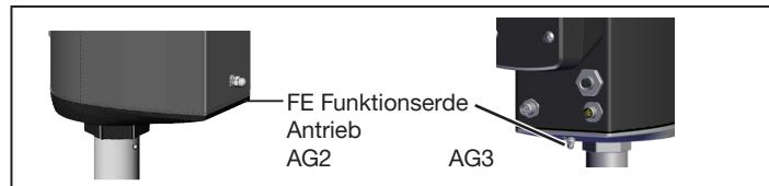
Abb. 17: FE Funktionserde am Antrieb
