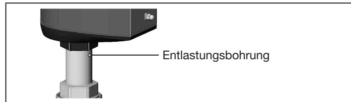
Abb. 38: Entlastungsbohrung
