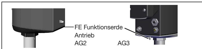
Abb. 16: FE Funktionserde am Antrieb
