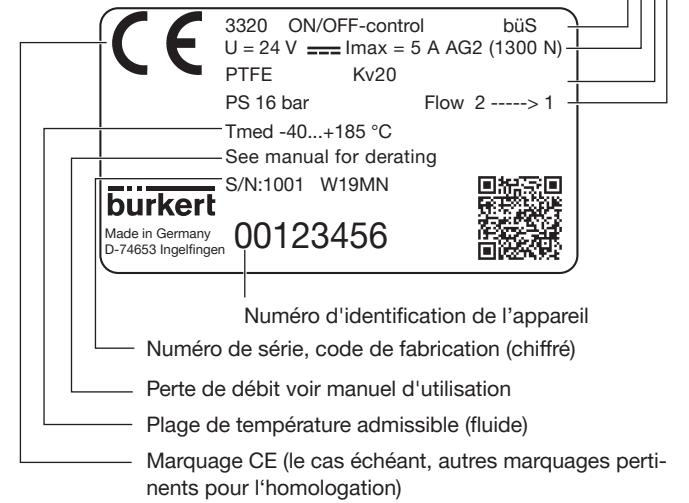
Fig. 4: Description de l'étiquette d'identification (exemple)
