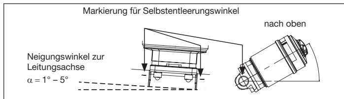
Bild 9: Einbaulage zur Selbstentleerung des Ventilgehäuses
