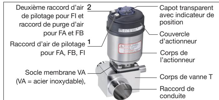
Fig. 3: Structure et description type 2104
