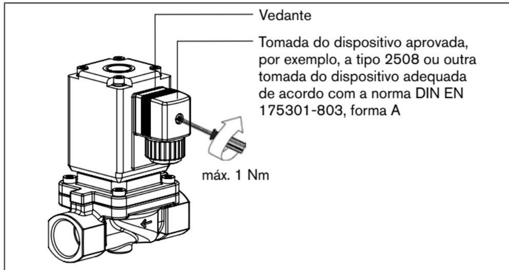
Imagem 3: Instalação elétrica
