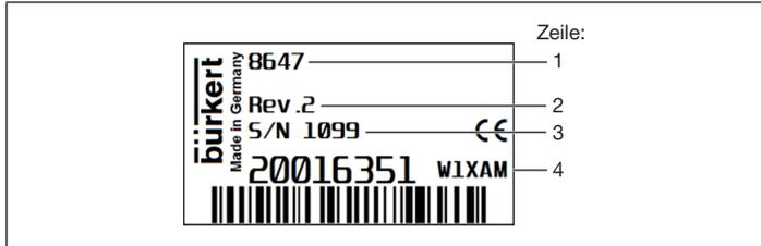
Bild 3: Beispiel eines Typschilds für den Ex-Bereich
