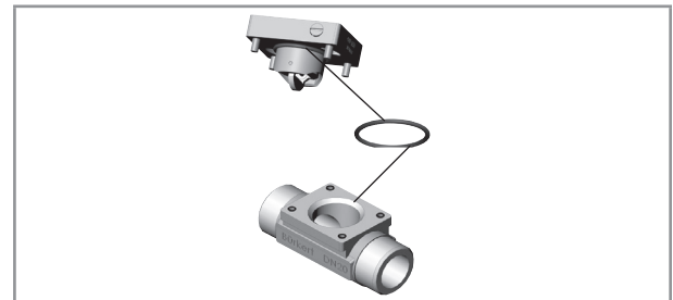
Fig. 6: Emplacement du joint sur un raccord S039
