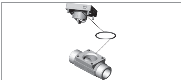
Fig. 5 : Emplacement du joint sur un raccord S030 HT
