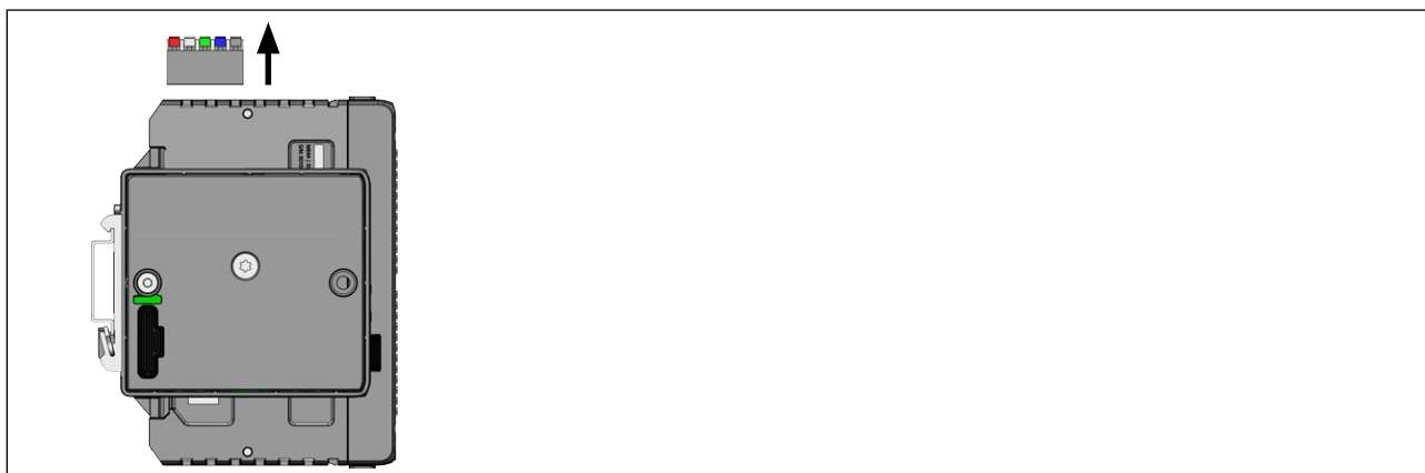
Ilustracja 29: Wyjęcie 5-biegunowego zacisku typu sprężynowego
