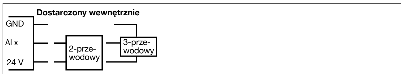
Ilustracja 8: Schemat połączeń – moduł 4AI, dostarczony wewnątrz
