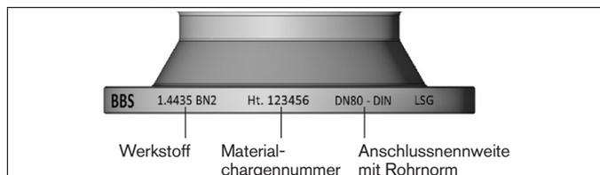
Bild 1: Beispiel für die Kennzeichnung des Produkts
