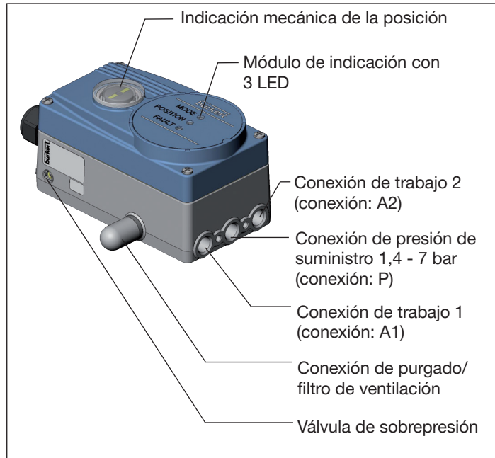
Imagen 1: Estructura del posicionador tipo 8791
