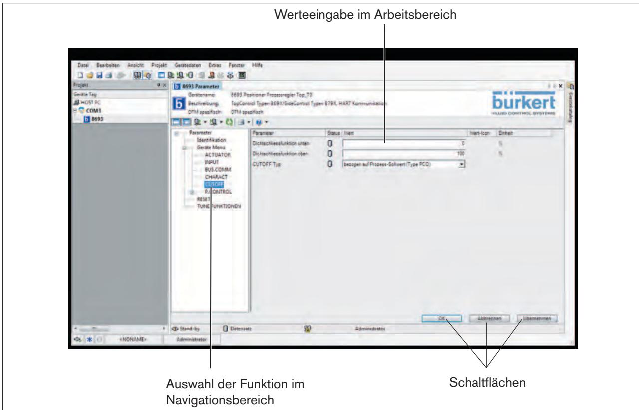
Bild 24: Parameter bei Funktionen einstellen
