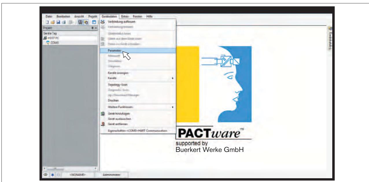
Bild 14: HART Kommunikations DTM - Parameter einstellen
