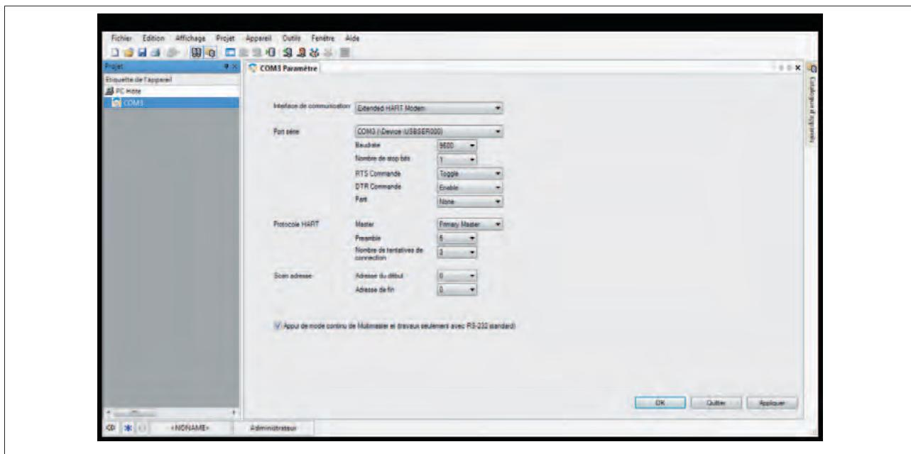
Figure 15 : Réglages du DTM de communication HART
