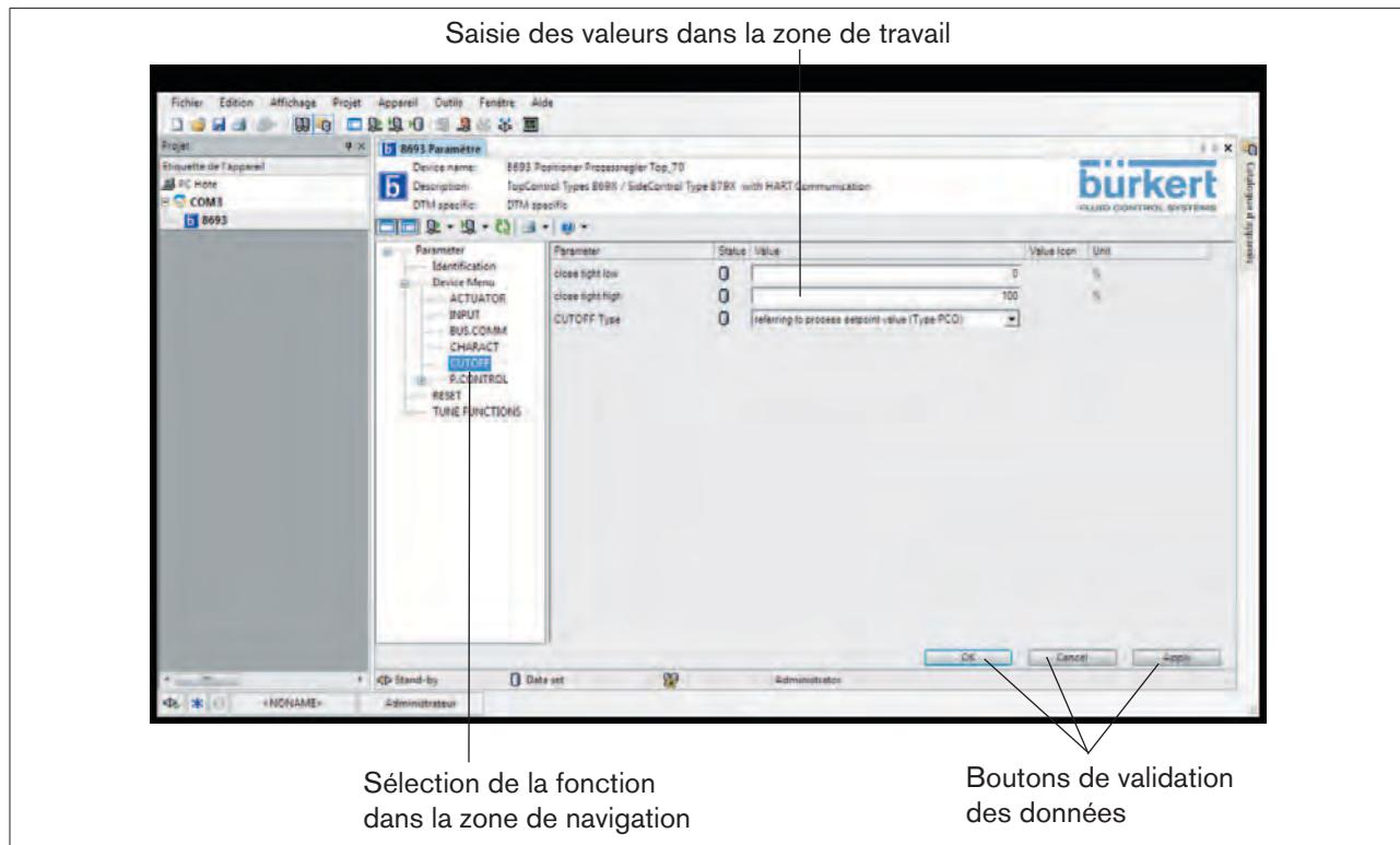
Figure 11 : Affichage écran d'un DTM Burkert
