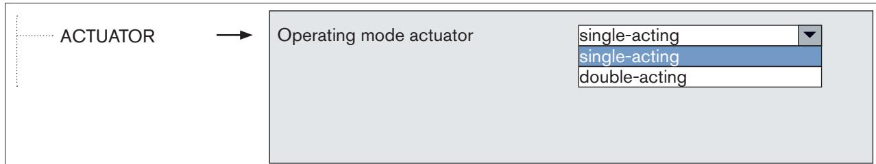
Figure 25 : Fonction ACTUATOR
