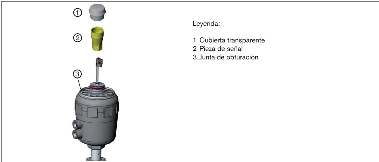
Fig. 7: Instalación de la junta de obturación
