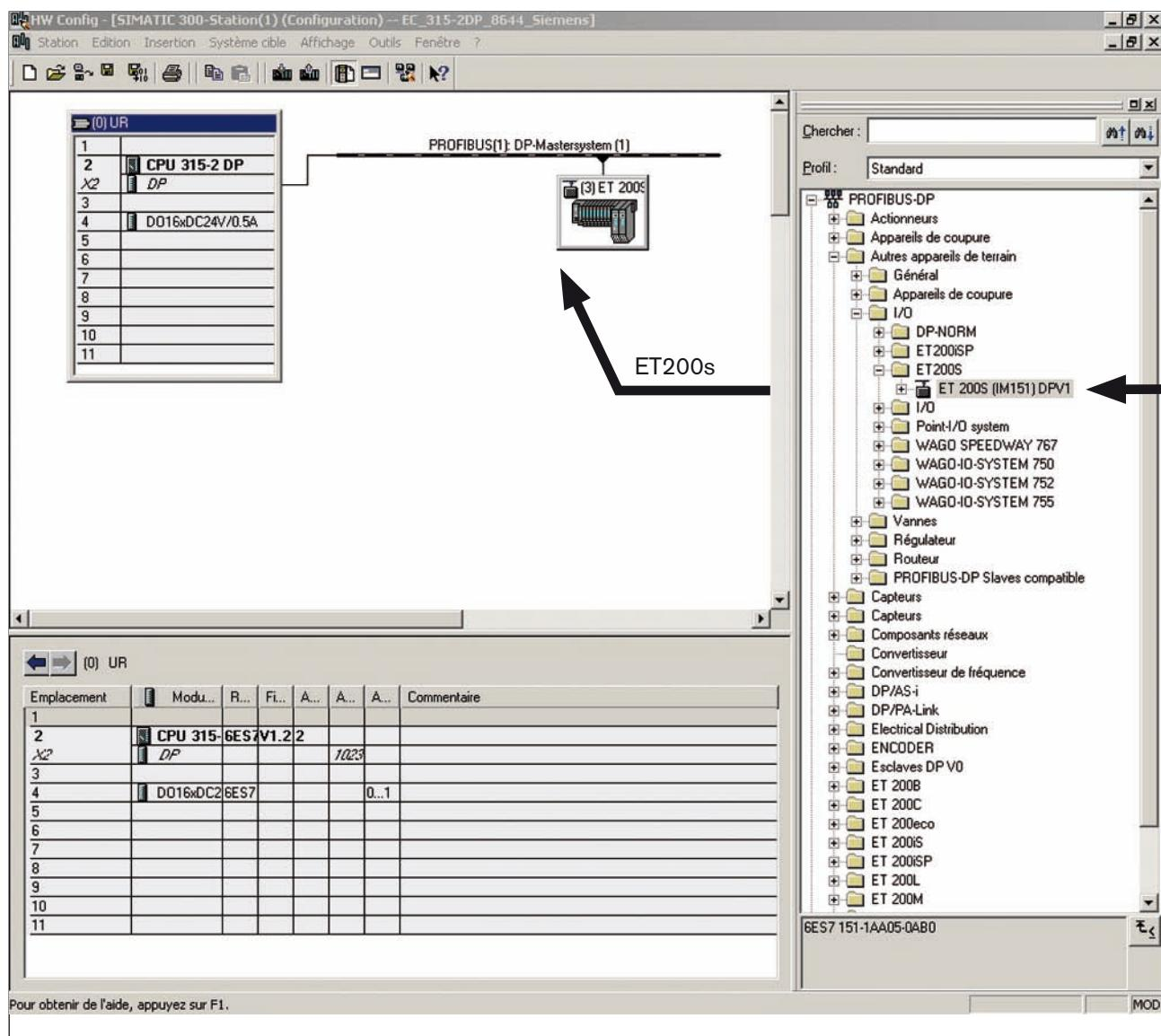
Figure 5 : Sélectionner l'esclave
