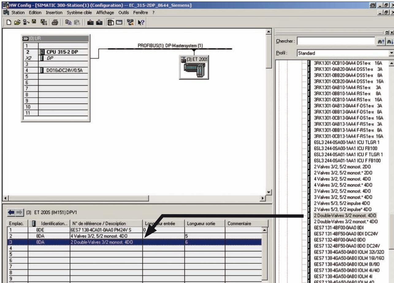
Figure 7 : Sélection des modules
