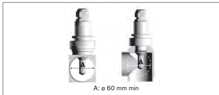
Figura 11: Posição de montagem do produto na tubulação
