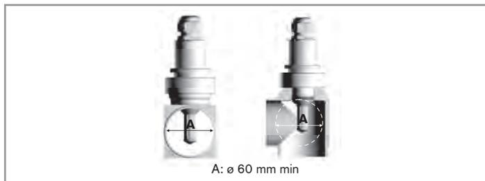
Fig. 11: Positionnement du produit sur la canalisation
