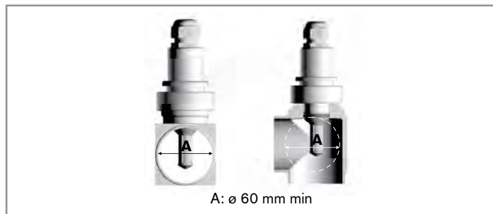
Bild 11: Montageposition des Produkts auf der Rohrleitung
