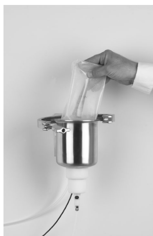
Imagen 8: Extracción de la botella de electrolito
