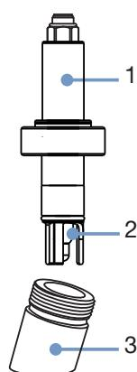
**1:** G 1 1/4"-Sondenhalter Typ 8200 mit O-Ring-Position von 28 mm oder 46 mm
