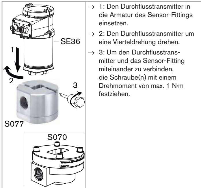
Bild 8: Montage des Durchflusstransmitters auf einem Sensor-Fitting
