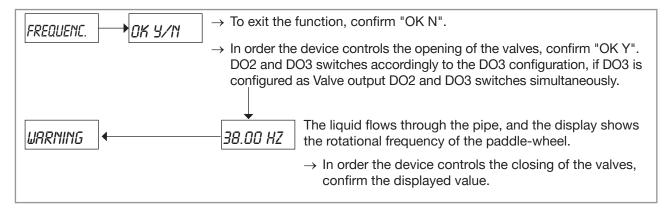
Fig. 96: Diagram of the "FREQUENC." parameter of the Test menu
