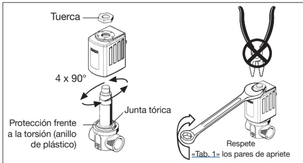
Imagen 1: Montaje de la bobina
