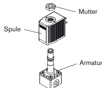
Spule und Armatur können komplett unter der Identnummer des Geräts bestellt werden (siehe Typschild).
