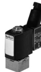
A tipo **6012P** é usada como uma válvula piloto especial para montagem direta em acionamentos pneumáticos de controle externo. Consiste no acionamento magnético do tipo 6012 e uma caixa básica com parafuso vazado que pode ser conectado diretamente à ligação do ar de comando do acionamento. A válvula é equipada com um acionamento manual de série.
