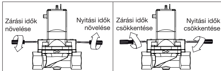
5. ábra: Kapcsolási idők növelése/csökkentése
