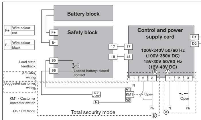
Fig. 10: Electric wiring
