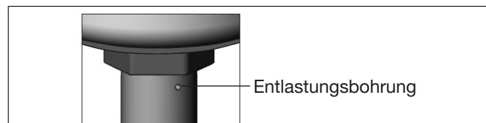
Bild 10: Entlastungsbohrung
