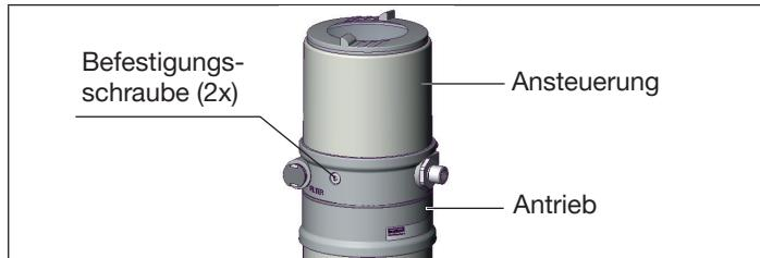
Antrieb vom Ventilgehäuse demontieren:
