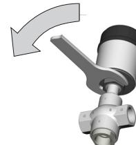
Fig. 3 : Tourner l'actionneur
