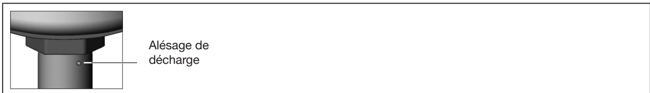
Fig. 7 : Alésage de décharge
