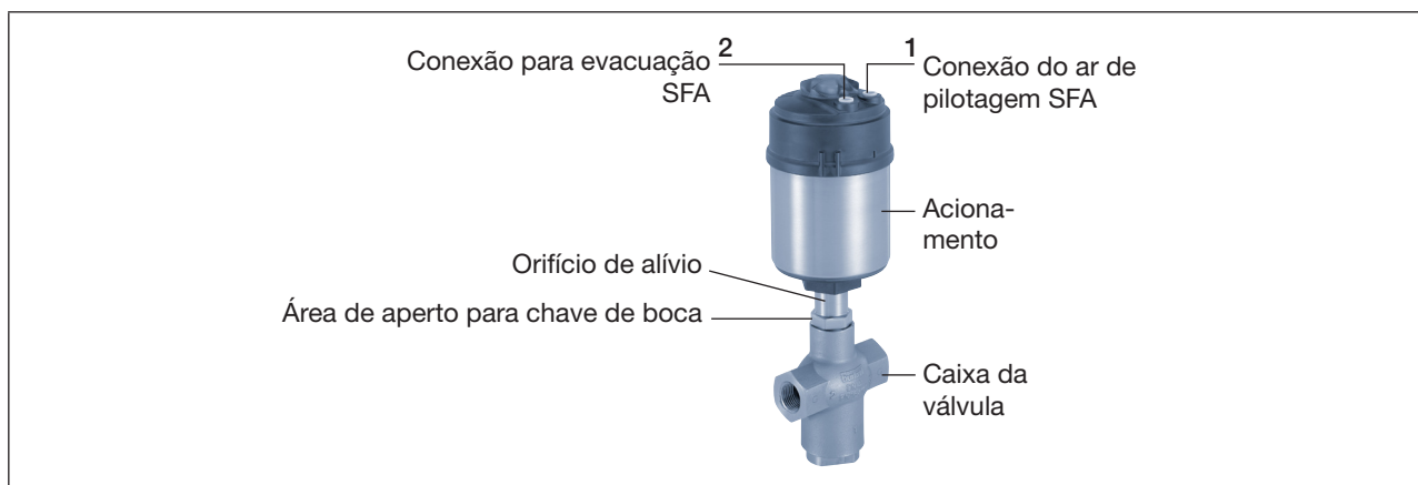
Figura 1: Válvula de cabeça reta 3/2 vias tipo 2106
