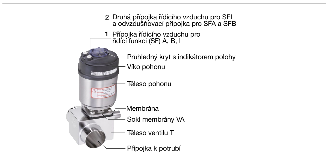
Obrázek 3: Konstrukce a popis typu 2104
