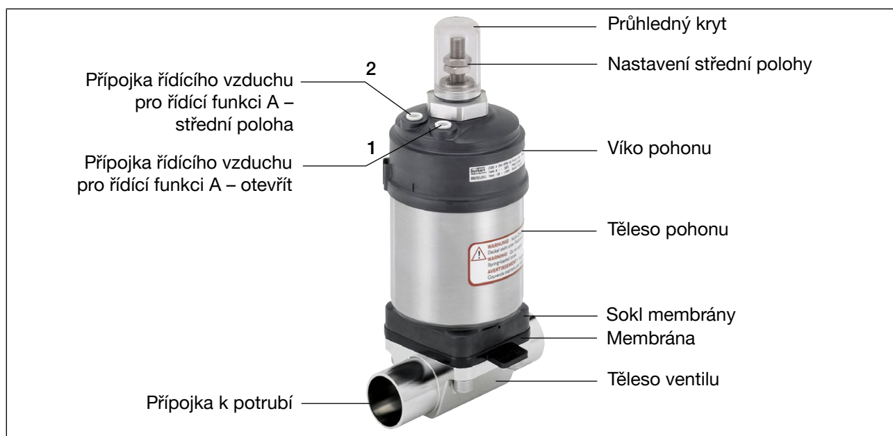
Obrázek 2: Konstrukce a popis, 2/3-cestný ventil typ 2103
